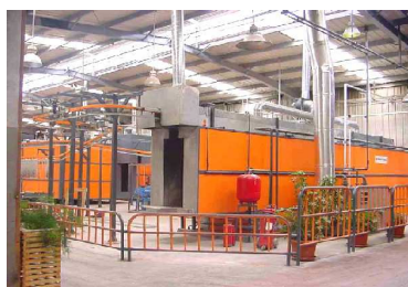
Nanos elektrostatičnega praškastega premaza v ABB ARAB
